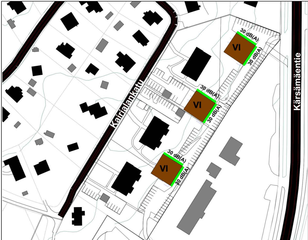
Kuva 2. Julkisivun ääneneristävyysvaatimukset tie- ja raideliikennemelua vastaan.
