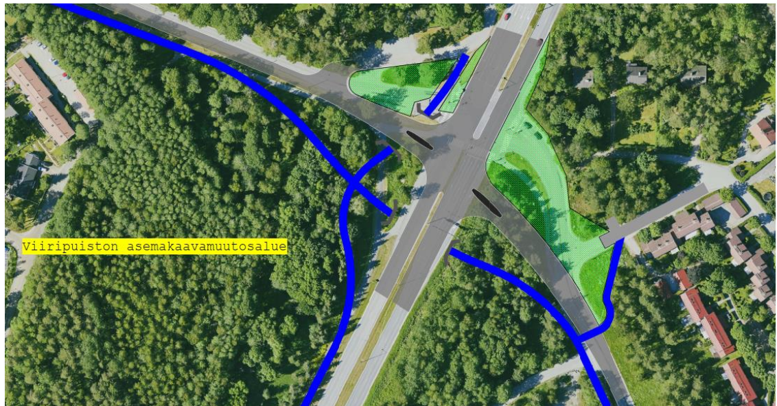
Ote liikenteen esiselvityksestä, tielinjaukset, pyörätiet ja alikulut Vahdontien ja Tampereentien risteyksen tuntumassa.
