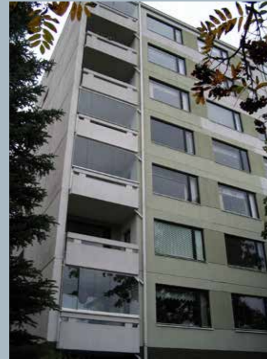
Rakennusliike Ruolan toteuttamissa 1970-luvulla valmistuneissa Lohjan Ojamonkankaan kerrostaloissa, toistuvat Hepokullasta tutut julkisivuaiheet, mm. ikkunoiden väliset betonirihlatut tehostepinnat ja sisäänvedetyt parvekkeet betonikaiteineen.
