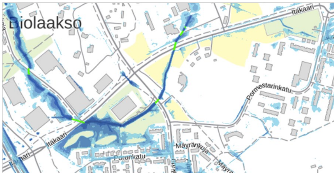
Kuva 6. Harvinaisen (toistuvuus kerran sadassa vuodessa) rankkasateen aiheuttama tulvatilanne. Tulva on esitetty sinisellä, mitä tummempi väri, sitä korkeampi vedenpinta. Suuremmat hulevesiviemärit ovat vihreällä.
