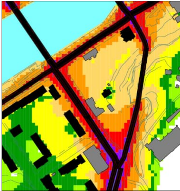
Kuva 11. Tieliikenteen päiväajan keskiäänitaso LAeq,7–22 kaava-alueella nykytilanteessa. Kuvassa näkyy Herkules-korttelin jo purettuja rakennuksia. (Kuva: Turun kaupungin meluntorjunnan toimintasuunnitelma 2018–2022.)
