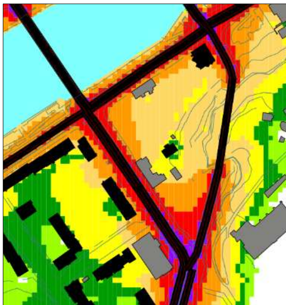
Kuva 8. Tieliikenteen päiväajan keskiäänitaso LAeq,7–22 kaava-alueella nykytilanteessa. Kuvassa näkyy Herkules-korttelin jo purettuja rakennuksia. (Kuva: Turun kaupungin meluntorjunnan toimintasuunnitelma 2018–2022.)
