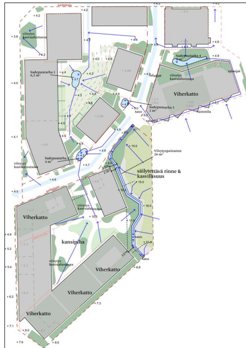
Kuva 49. Kaavamuutosalueen hulevesien hallinnan periaatteet, Lundén Architecture Company 28.5.2025.
