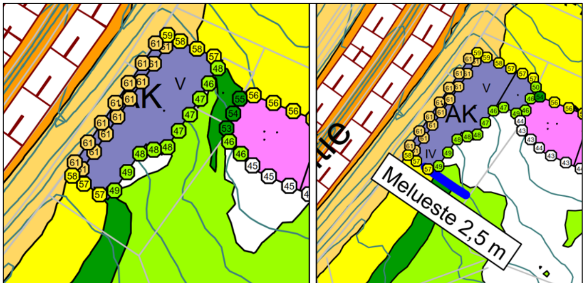
Kuva 3. Skarppakullantien viereisen AK korttelin keskiäänitasot yöaikaan L_{Aeq, 22-7} ilman meluntorjuntaa vasemmalla ja meluntorjunnalla oikealla. Kuvasta nähdään, että 2,5 m korkea meluseinä Sorakadun suuntaisesti suojaa tonttia tehokkaasti melulta.
