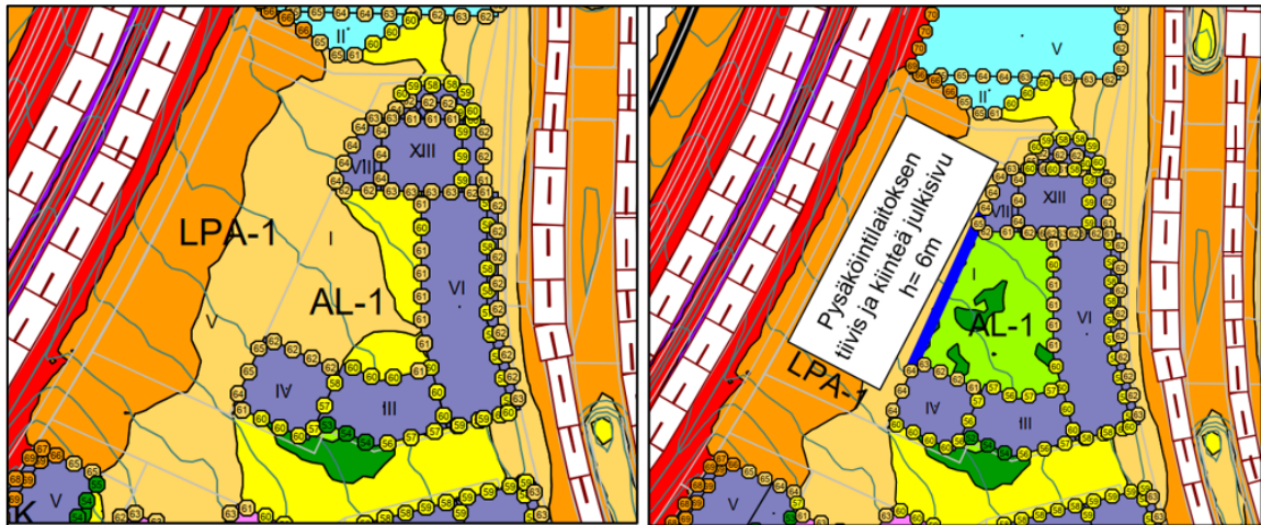
Kuva 4. Vasemmalla on esitetty päiväajan L_{Aeq, 7-22} melutilanne, jossa pysäköintilaitos toteutuisi kauttaaltaan avoimena ja ääntä läpäisevänä rakenteena. Oikealla on esitetty melutilanne, kun pysäköintilaitos on toteutettu kahden kerroksen korkeudelta asuinkorttelin sisäpihan puolelta tiiviinä ja kiinteänä rakenteena.
