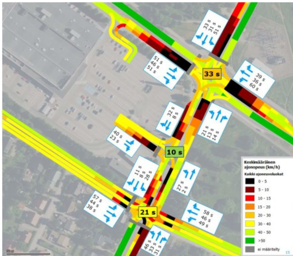
Kuva 46. Liikenteen sujuvuutta kuvaavat simulointien mukaiset keskimääräiset ajonopeudet (vas.) sekä jonopituudet, kun Jaanintien ja Prisman liittymä on valo-ohjattu ja Jaanintie nelikais-taistettu. © Ramboll
