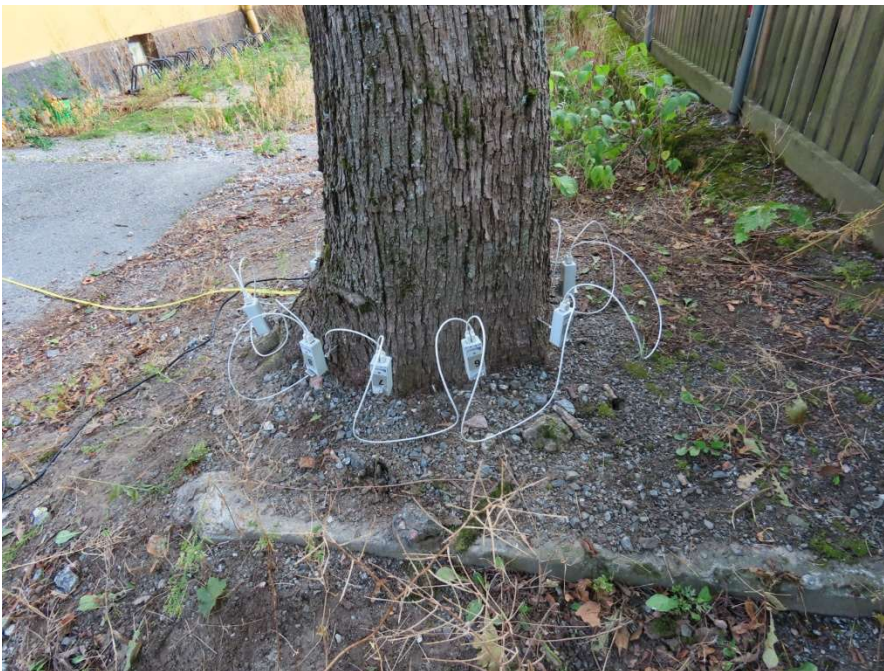
Kuva 15. Puun tyvialue ja tomografisensorien sijainnit.
