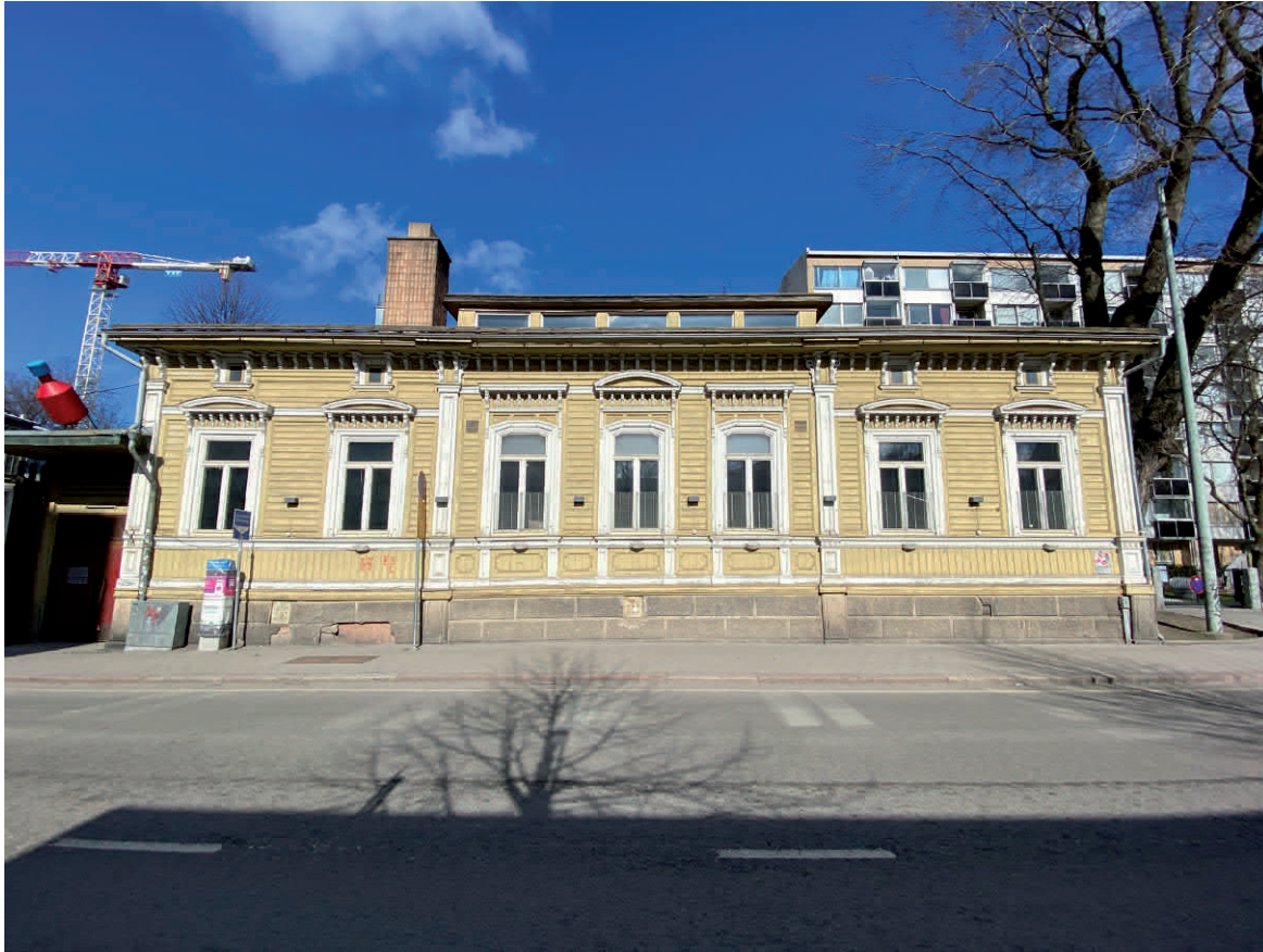
Rakennuksen julkisivu on pääosin vuoden 1885 asussa, detailjiikkaa myöten lukuun ottamatta ikkunoita, kattoikkunaa ja vuonna 1954 lisättyä porrashuonetta.
