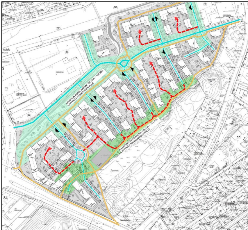
Kuva 46 a. Esitys alueen korttelialueiden liittymisestä katuverkostoon (mustat nuolet), ajoneuvoliikenteen reitit (turkoosi), jalankulku- ja polkupyöräreitit (keltainen) ja pelastusajoneuvojen reitit (punainen). Suunnittelutilanne 19.4.2018 / Arkk.tsto Haroma & Prtners Oy
