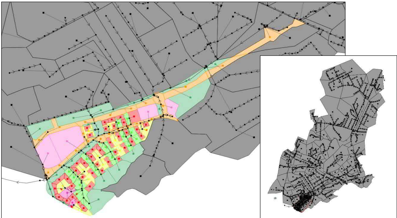
Kuva 12. Työssä laadittu SWMM-hulevesimalli, jossa on mukana koko Saukonojan suunnittelualan yläpuolinen valuma-alue.
