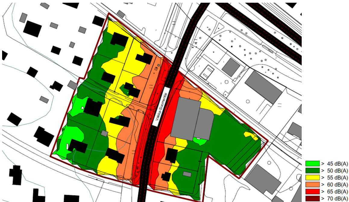
Kuvassa tieliikenteen aiheuttamat päiväajan melutasot nykyisellä maankäytöllä ja ennustevuoden 2030 liikenteellä
