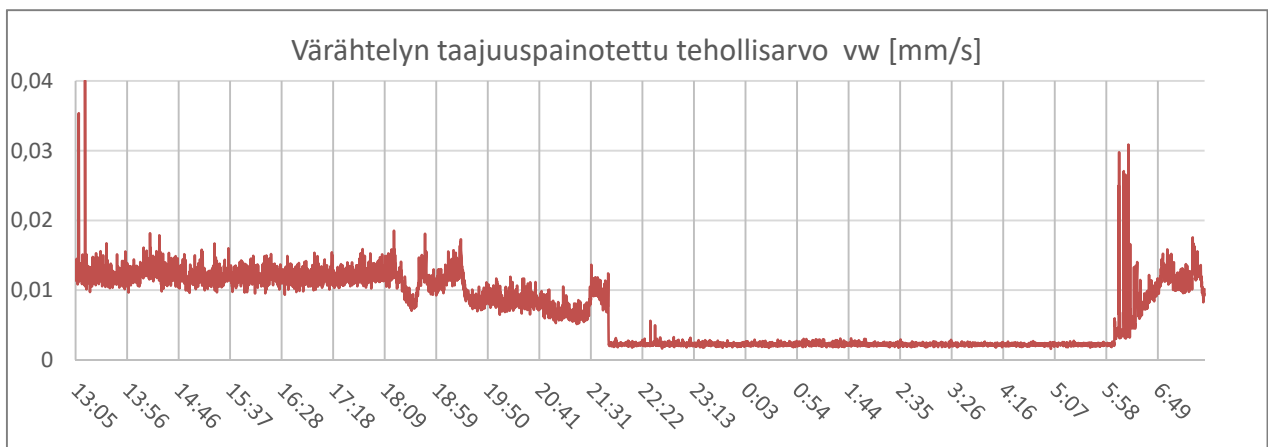
Kuva 4. Värähtelyn taajuuspainotettu tehollisarvo värähtelyvoimakkuudeltaan suurimmassa akseli-suunnassa mittauspisteessä 2, taso +18.60.
