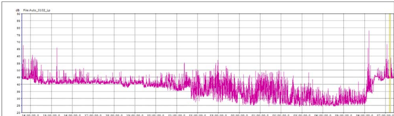
Kuva 3. Äänitasokuvaaja mittauspisteessä 2, taso +18.60, lämpölaitoksen kattotason yläpuolella.
