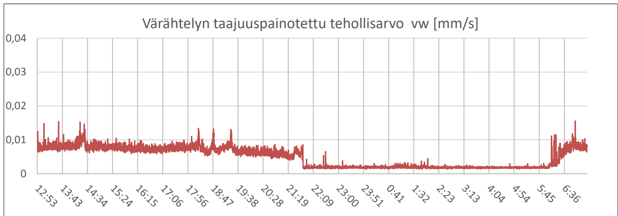
Kuva 2. Värähtelyn taajuuspainotettu tehollisarvo värähtelyvoimakkuudeltaan suurimmassa akseli-suunnassa mittauspisteessä 1, taso +23.60.
