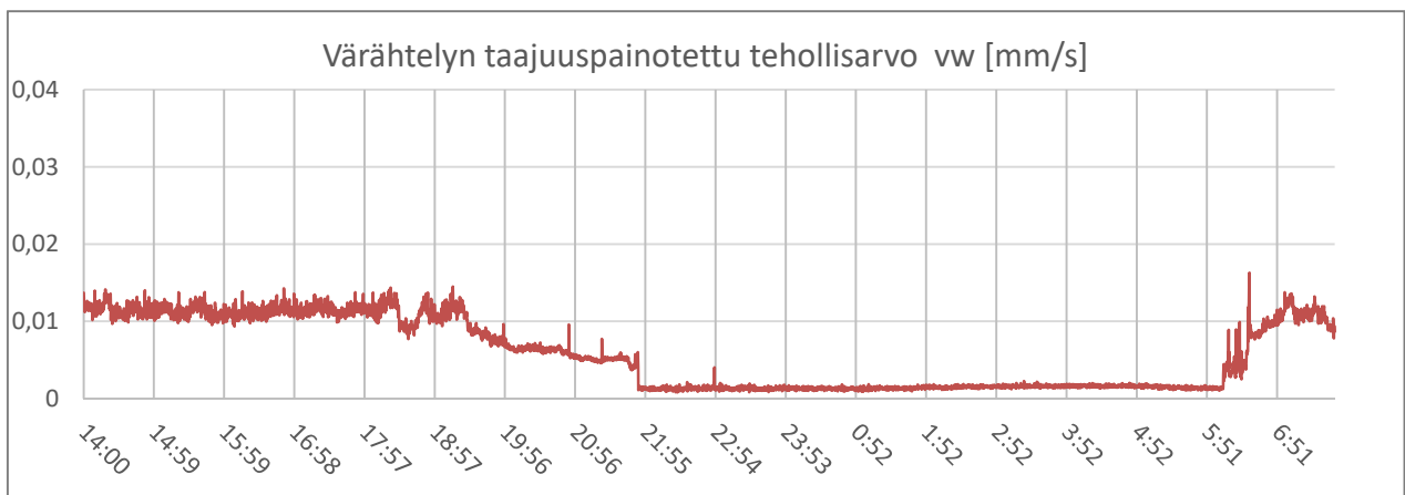
Kuva 8. Värähtelyn taajuuspainotettu tehollisarvo värähtelyvoimakkuudeltaan suurimmassa akseli-suunnassa mittauspisteessä 4, taso +6.00, pohjakerros.
