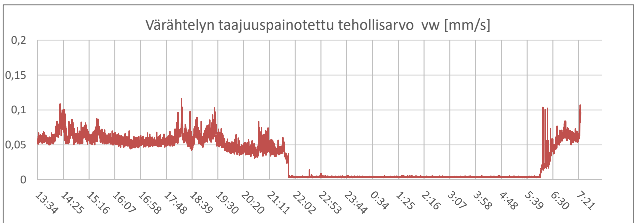
Kuva 10. Värähtelyn taajuuspainotettu tehollisarvo värähtelyvoimakkuudeltaan suurimmassa akseli-suunnassa mittauspisteessä 5, taso +14.00, Linnankadun puoleinen halli.
