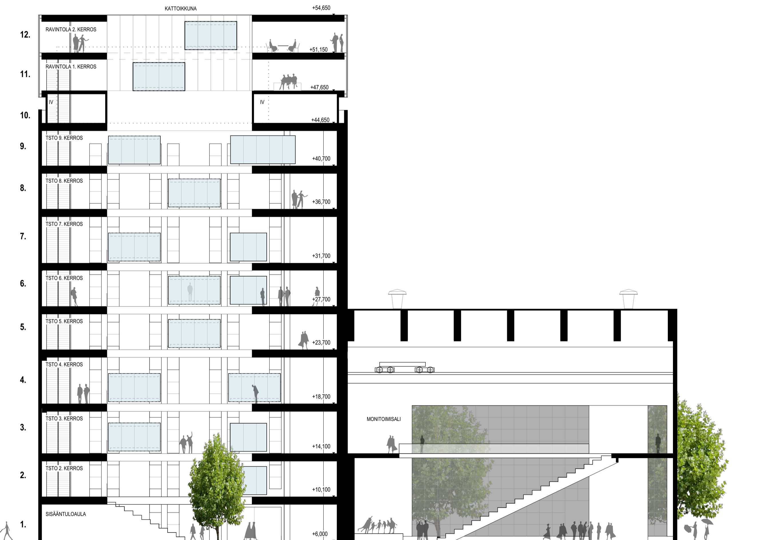
VOIMALAITOKSEN KATTILATORNI | LEIKKAUS A-A
