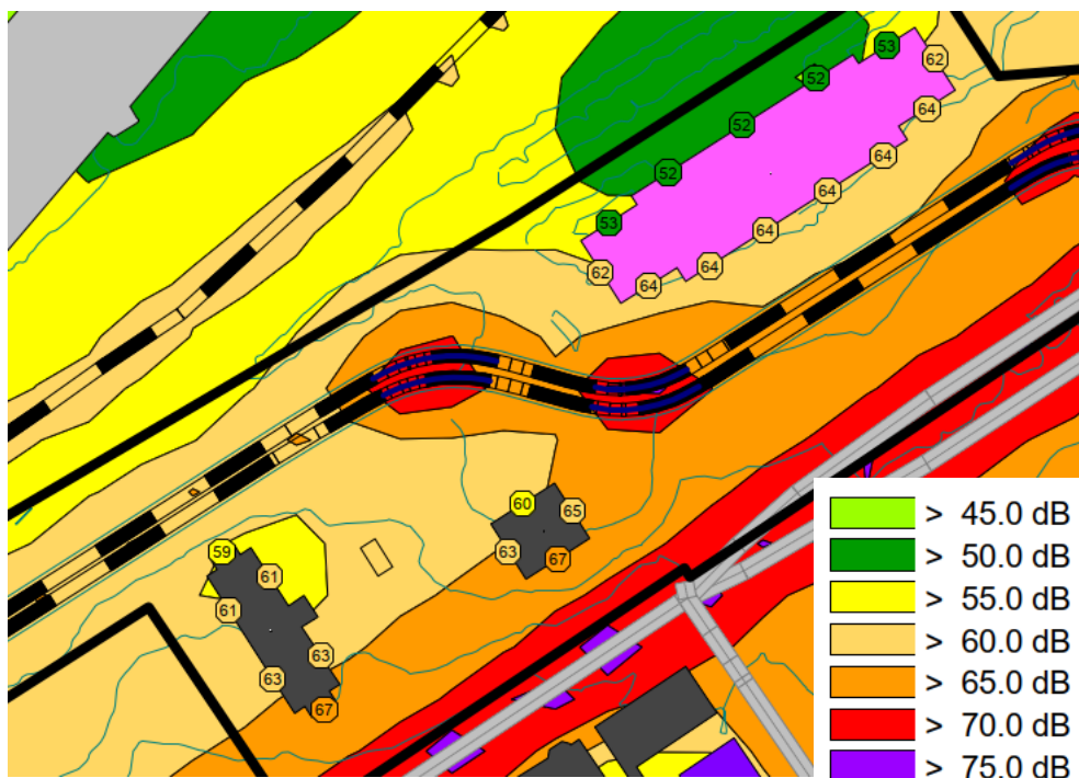
Kuva 28. Kuvassa esitetään ennustetilanteen mukainen tie-, rautatie- ja raitiotieliikenne raitiotieliikenteen aiheuttamat enimmäisäänitasot asuinrakennusten julkisivuilla. Päiväajan keskiäänitaso L_{Aeq,7-22} . (Sweco Finland Oy, 6.11.2025)
