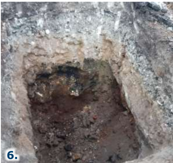
Kuva 6. Koekuopan 15 maakerrokset erottuvat selkeästi, asfaltin alla on eri täyttömaakerroksia noin metrin syvyyteen asti, minkä alla on jätteellinen täyttömaakerros saven pintaan asti.
