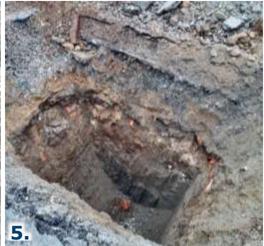
Kuva 4. Koekuopassa KK11 todettiin noin 1,5 m paksuinen jätteellinen täyttökerros. Maa-aineksen joukossa todettiin rakennusjätteen lisäksi sekalaista orgaanista ja epäorgaanista jätettä.
