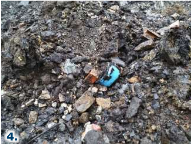
Kuva 4. Koekuopassa KK11 todettiin noin 1,5 m paksuinen jätteellinen täyttökerros. Maa-aineksen joukossa todettiin rakennusjätteen lisäksi sekalaista orgaanista ja epäorgaanista jätettä.
