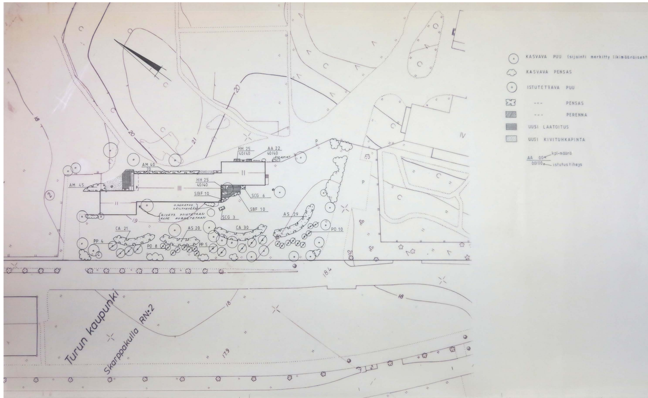
Kurjenmäen toimintakeskus, ympäristön kunnostamissuunnitelma 13.7.1968. Piha-alueelle on merkitty betonikiveyksellä päällystetty oleskelualue, myös uuden sisäänkäyntiluiskan viereen on merkitty betonikiveys. Vanhoja kiveyksiä on poistettu ja pihaa on jäsennelty rajaavin pensasistutuksin. KA
