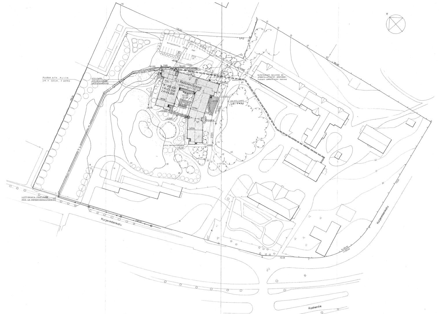
Kurjenmäkikoti 1, asemapiirros. pääpiirustukset 30.11.1987. Arkkitehtitoimisto Jarmo Saarinen. Kaksikerroksinen atriumpihan ympärille kietoutuva vanhainkotirakennus on sijoitettu tontin koillisosan rinteeseen. Atriumpiha avautuu mäen kumpareelle sijoittuvan yhteispihan suuntaan. Pääsisäänkäynti sijoittuu eteläisivulle. RVV
