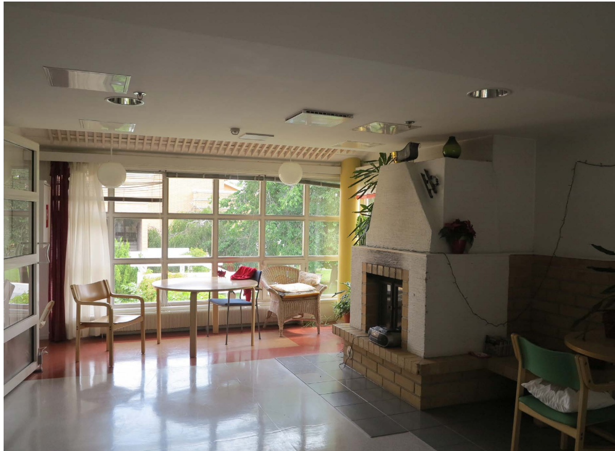
Kurjenmäkikoti 2, 2.kerrosen oleskelutilaan liittyy kohteeseen erikseen suunniteltu muurattu takka. Takassa toistuu julkisivun kellertävä tiili. Tila saa luonnonvaloa rungon molemmin puolin sijoittuvista suurista ikkunaseinistä.
