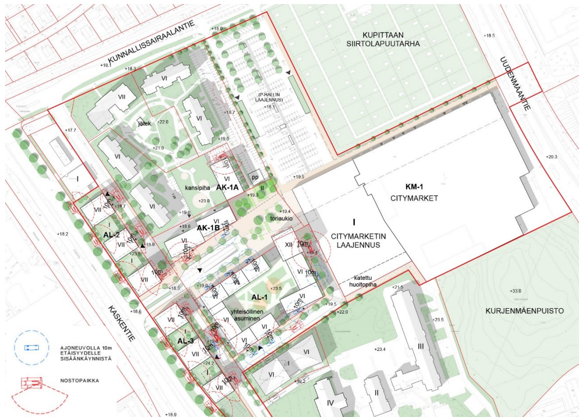
Kuva 27. Pelastuskaavio, viitesuunnitelma 27.9.2024. © ARCO Architecture Company Oy
