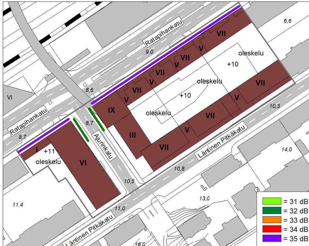
Kuva 11 Vähimmäisvaatimusta 30 dB korkeammat julkisivujen äänitasoero-vaatimukset asuin- ja majoitushuoneistoille. Toimisto- ja liiketilojen vaatimukset ovat esitettyjä 10 dB pienempiä.
