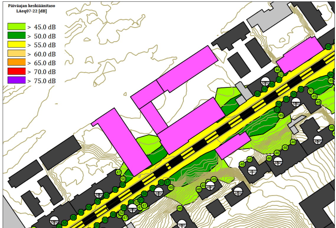
Kuva 7 Raitiotieliikenteen aiheuttama päiväajan keskiäänitaso L Aeq 7–22 (ote yleissuunnitelman meluselvityksen liitekartasta).
