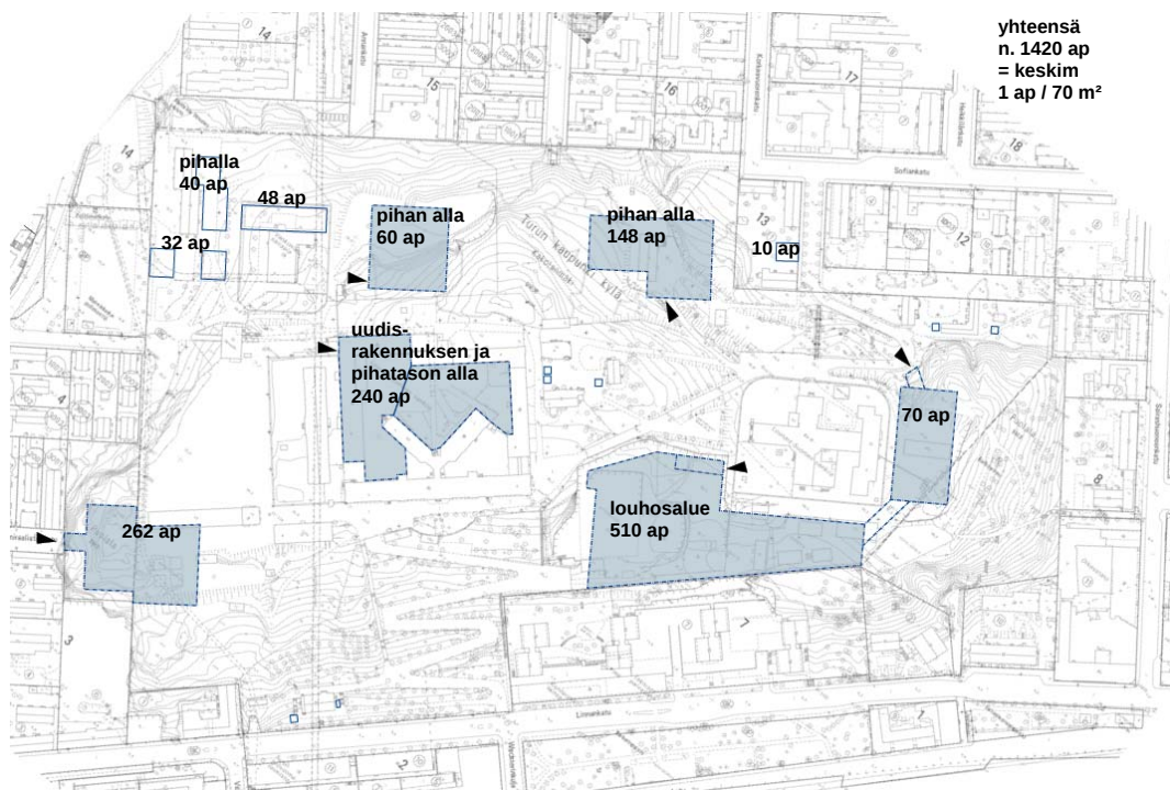
Rakennusryhmäkohtaiset maanalaiset autopaikat
