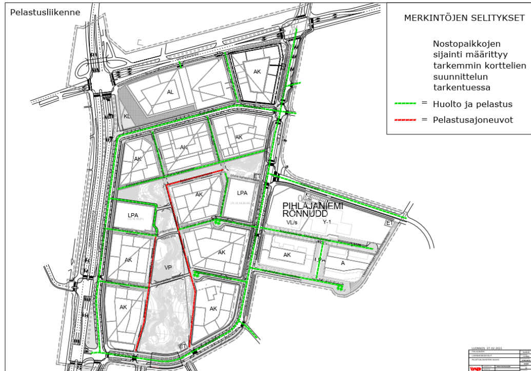
Kuva 52. Huolto- ja pelastusliikenteen yhteydet kaava-alueella.
