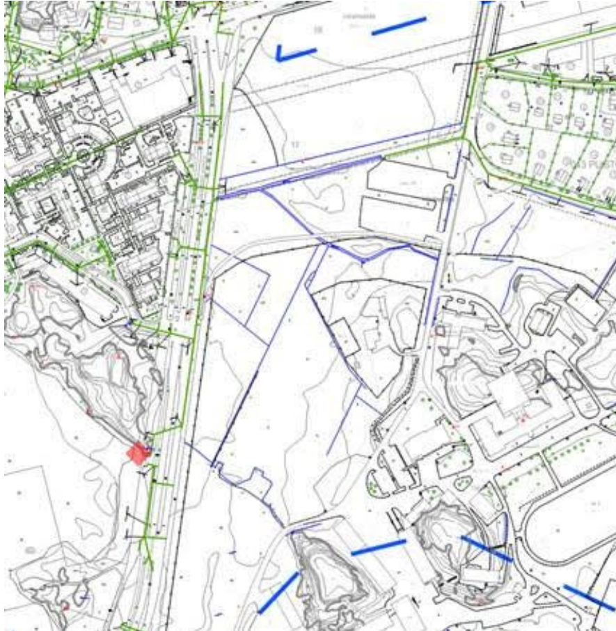
Kuva 11. Suunnittelualan hulevesiviemärit ja ojat. Idästä tulee alueelle 1800 mm putki. Hirvensalon puistotien alla on vastaavasti 1800 mm putki. Purkupiste merkitty kuvaan punaisella.
