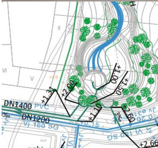
Kuva 13 Tyypikkuva hulevesipuiston virtauksen säätörakenteesta
