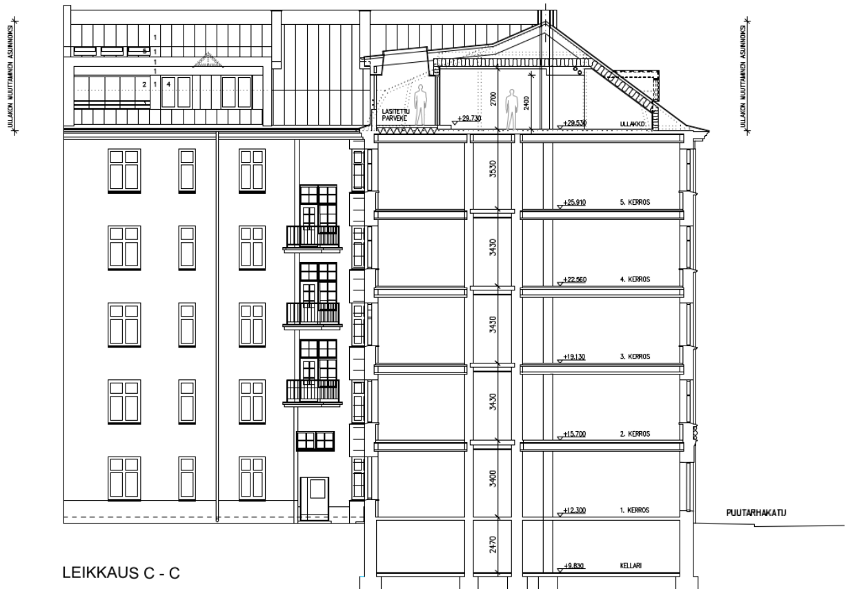
Kuva 15. Leikkauspiirustus ullakkorakentamisesta. Piirustus ei mittakaavassa. Haroma & Partners Arkkitehtitoimisto. 20.1.2023.
