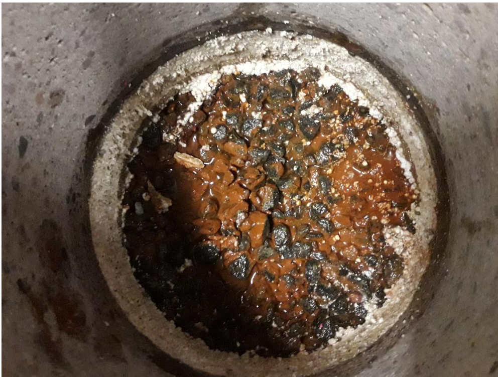
Kuva 8. Uima-altaan konehuoneen lattian alapuolisesta näytepisteestä ei saatu näytettä, koska maa-aines oli liian karkeaa. Kuvan sora on näytepisteestä R1.
