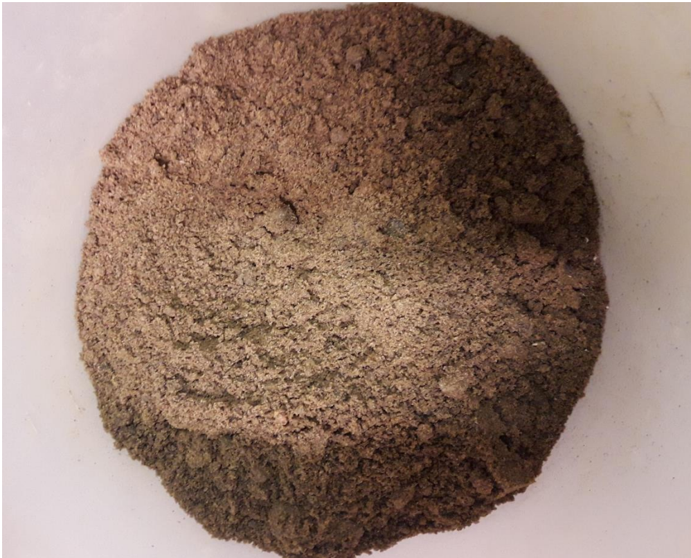
Kuva 7. Rakennusten alapuolinen maa-aines oli pääasiassa hiekaista täyttömaata. Kuvan näyte on pisteestä R10.
