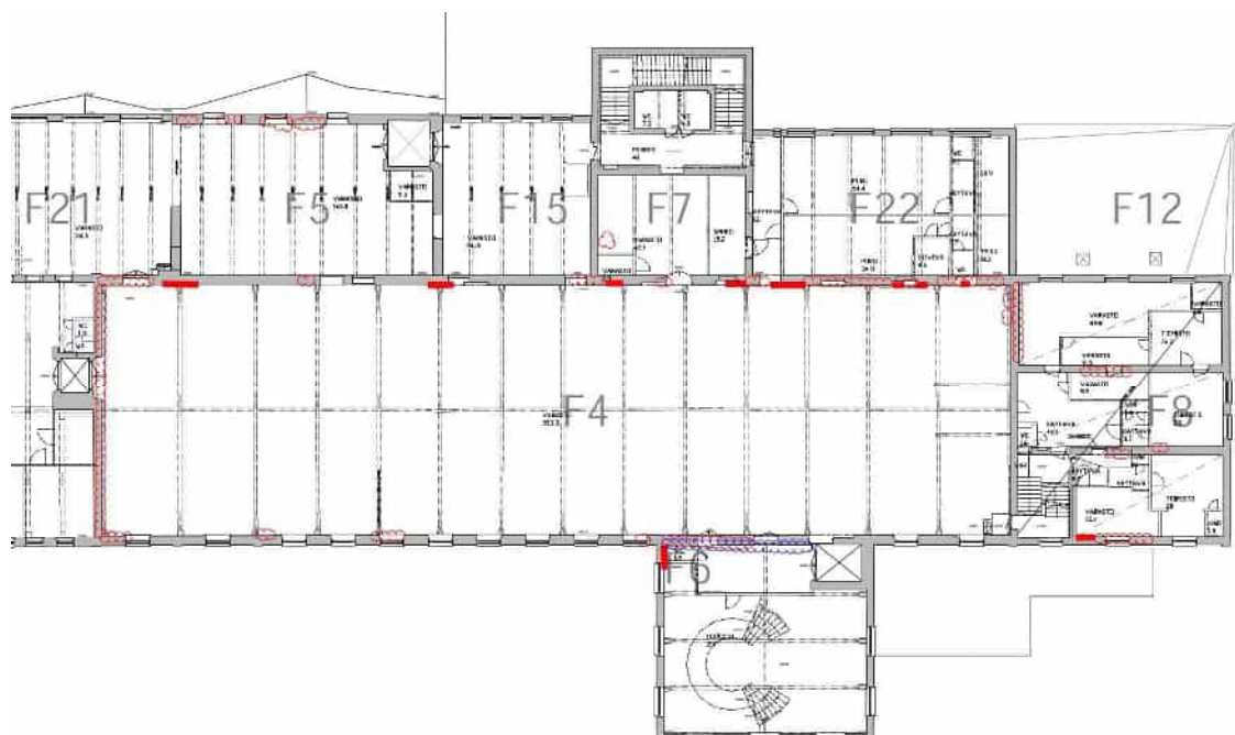
Kuva 19. Neljännen kerroksen kohdalla osan F4 seinälinjalle liittyvät vesikatot (F21, F5, F15, F7 ja F22) ja osan F8 liittymä osaan F4, sekä todennäköiset vanhat räystäsvuodot osissa F4 ja F5 ja nykyinen vuoto osassa F8. Punaisella viivalla on esitetty seinän yläosan koholla olevat pintakosteusalueet. Punaiset pilvet kuvaavat seinän yläosan kosteusjälkiä ja siniset seinän alaosan jälkiä, näissä kohdin pintakosteusilmaisimen lukemat eivät olleet koholla.
