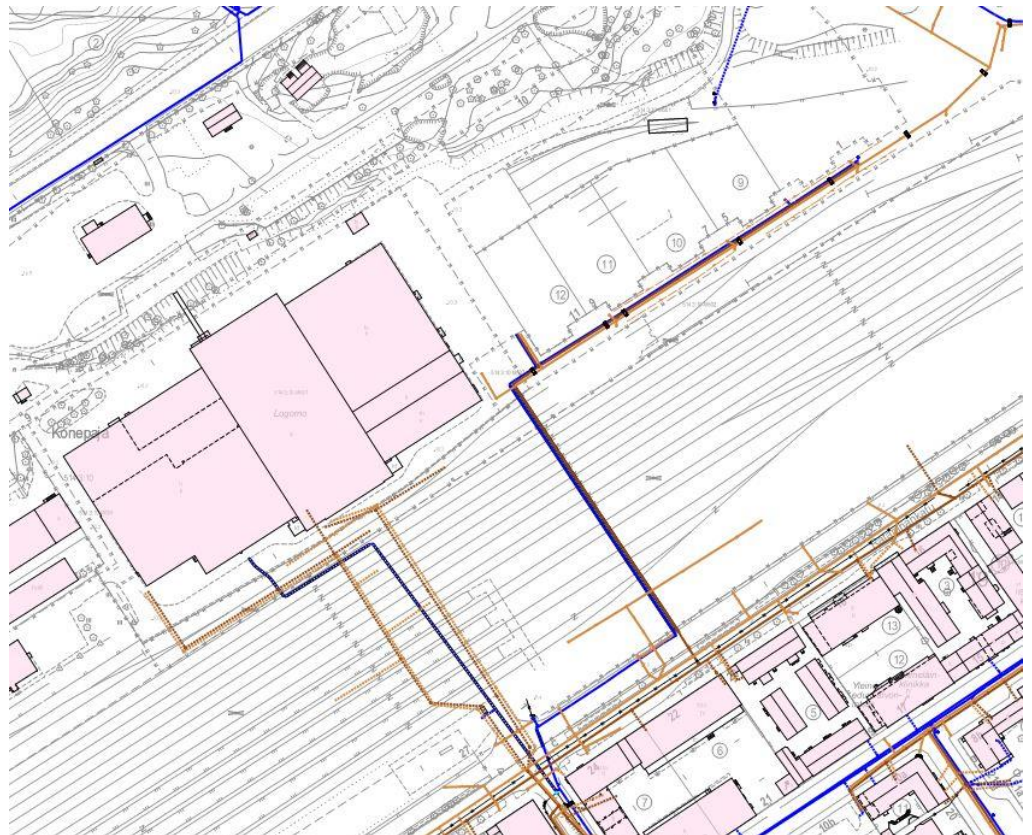
Vesi-, hulevesi- ja viemäriinjat kulkevat suunnittelualueelle ja Logomoon ratapihan poikki (kuvassa ruskeat ja siniset viivat).
