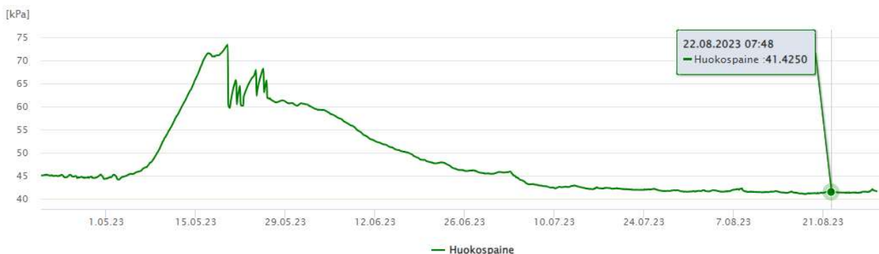
Kuva 4. Pietsometrin 1005 mittaustulokset kuuden metrin mittaussyvyydeltä.
