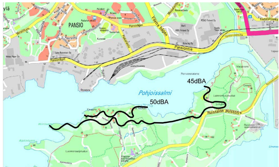
Kuva 13: Envimetria Oy:n vuonna 1999 suorittamien mittauksen tulosten perusteella arvioidut 45/50 dBA:n melualueet Ruissalossa, Pansion satamassa Railshipi.
