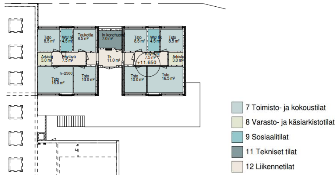
Kuva 85. Toimisto-osan tilajako. (Lähde: Arkkitehtitoimisto Ark'Aboa Oy)
