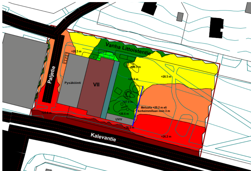
Kuva 19 Oleskelupiha-alueelle saadaan melulta suojattua oleskelualueita rajaamalla pihaa meluaidalla, jonka yläreuna ulottuu korkotasoon +29.2 m. Korkeimmillaan meluaita on tällöin Kalevantien varrella noin 3 metriä korkea. Kuva: Promethor Oy
