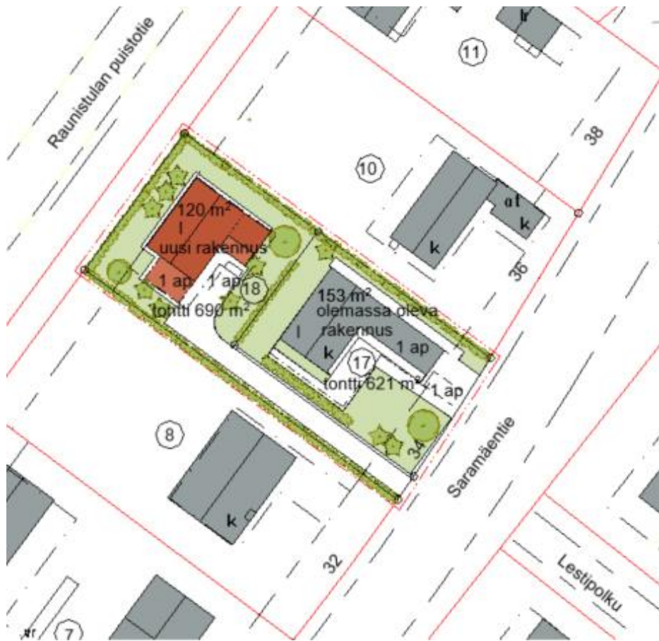
Kuva 15. Viitesuunnitelma 2, jossa rakennuksen kerrosala 120 k-m 2 on kokonaan 1. kerroksessa.
