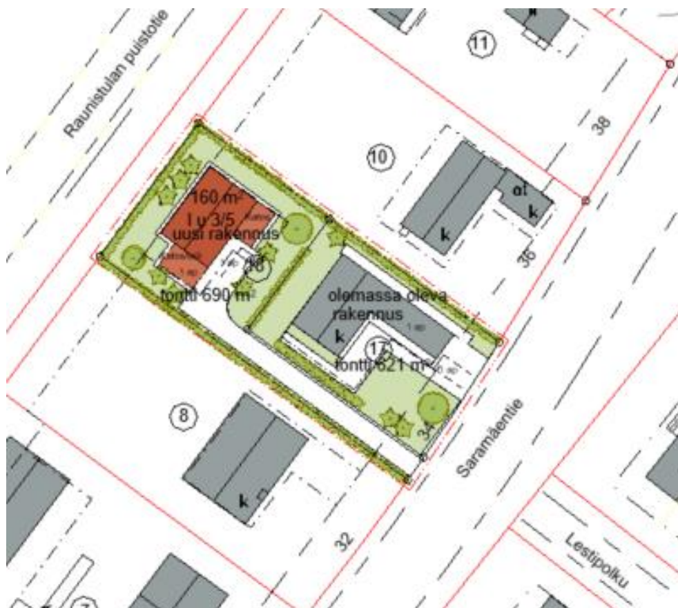
Kuva 12. Viitesuunnitelma 1, jossa rakennuksen kerrosala on 160 k-m 2 (1. kerroksessa 100 k-m 2 ja ullakolla 60 k-m 2 ).
